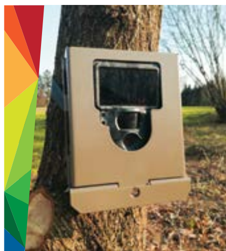
Lijevo: Tragovi medvjeda i vuka u sloju pijeska kojim se prati učinkovitost objekata za premošćivanje (Huber Đ.) Desno: Suvremene foto-zamke mogu detektirati životinje koje prelaze i u dnevnim i u noćnim uvjetima pomoću 940 nm infracrvenog svjetla (reflektora) koje je sisavcima nevidljivo (Potočnik H.)
