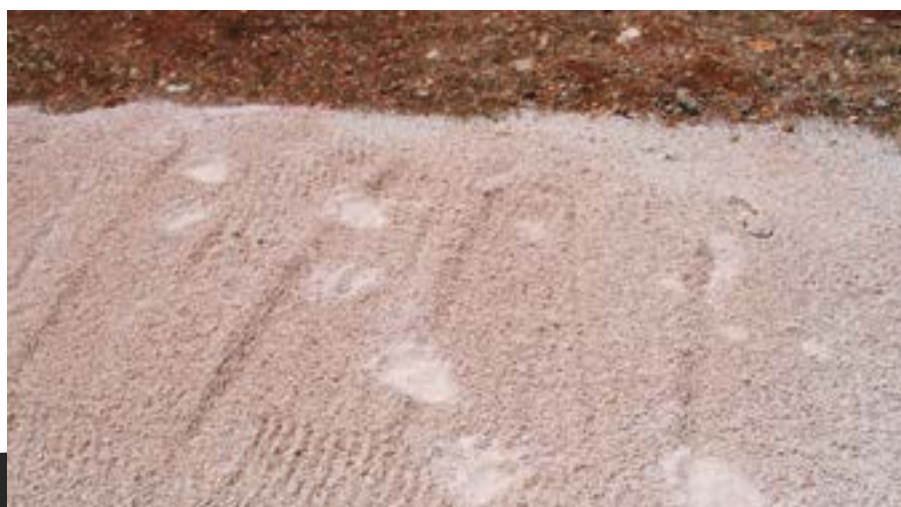
Lijevo: Tragovi medvjeda i vuka u sloju pijeska kojim se prati učinkovitost objekata za premošćivanje (Huber Đ.) Desno: Suvremene foto-zamke mogu detektirati životinje koje prelaze i u dnevnim i u noćnim uvjetima pomoću 940 nm infracrvenog svjetla (reflektora) koje je sisavcima nevidljivo (Potočnik H.)
